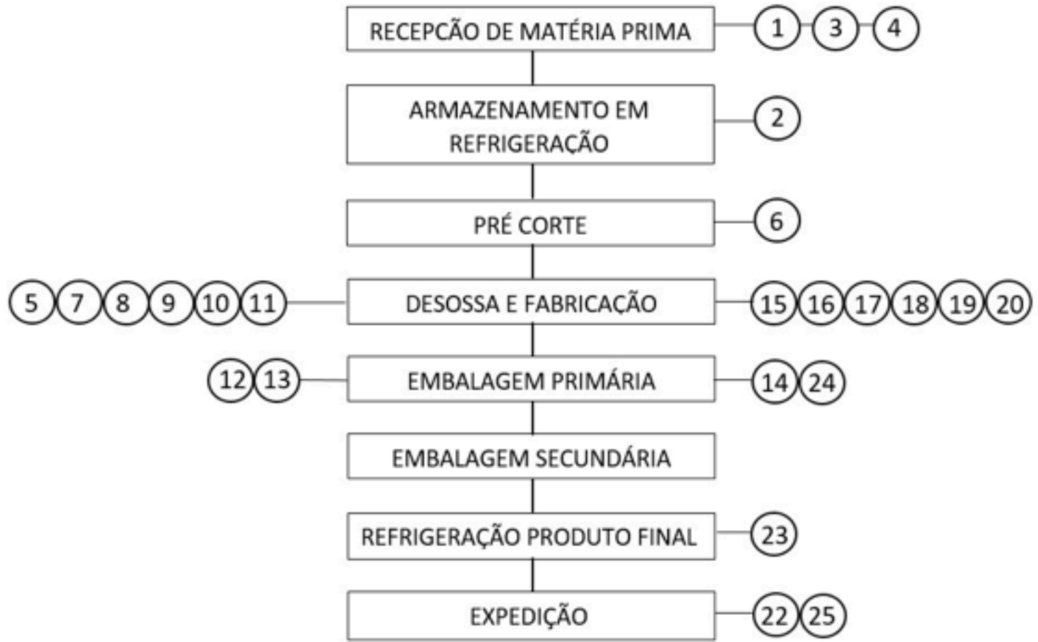
Figura 2 - Fluxograma dos pontos de coleta de amostras no processo produtivo frigorífico determinados pelo diagrama decisório.
