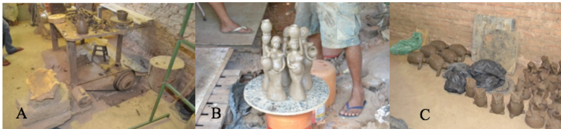
Figura 10. Processo de moldagem das peças cerâmicas pelos artesãos do Polo Cerâmico do Poti Velho, Teresina, Piauí: (A) em torno elétrico, (B) peças moldadas (C) secagem das peças (C).
