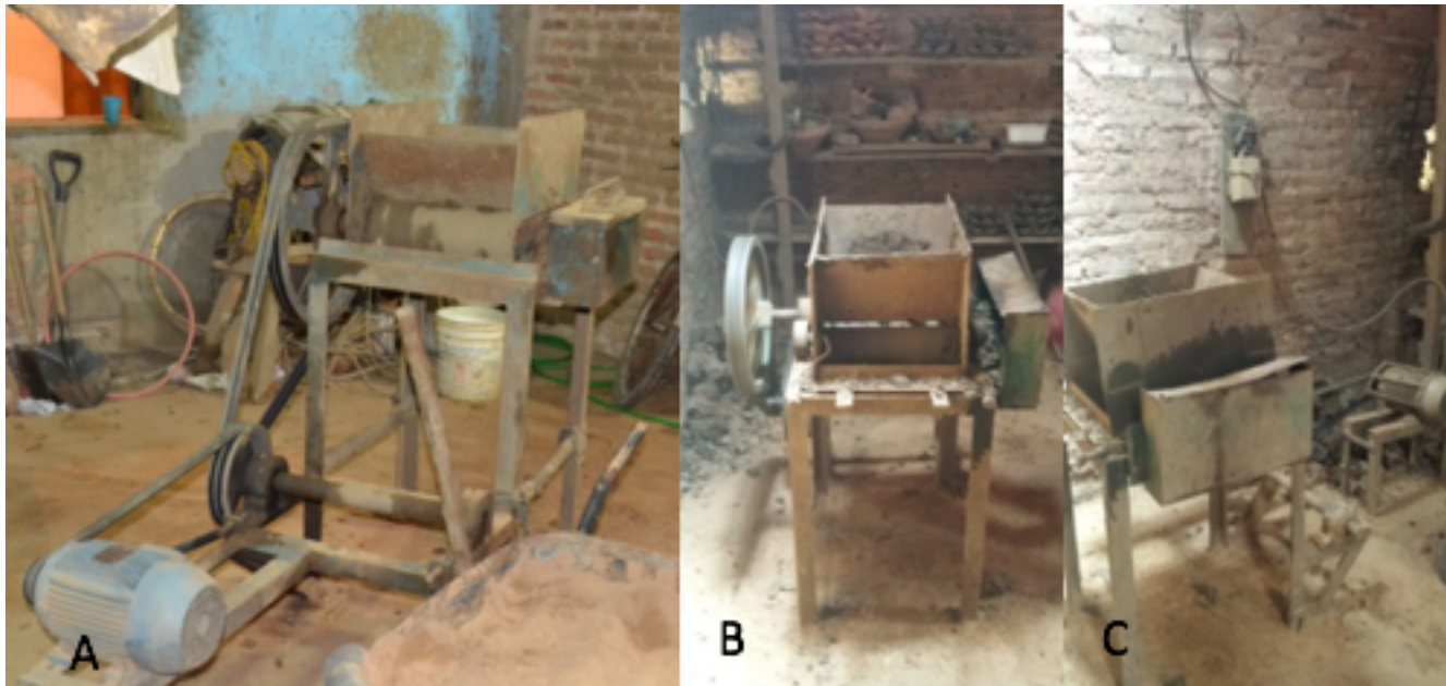
Figura 7. Cilindros mecânicos movidos à eletricidade, utilizadas pelos artesãos do Polo Cerâmico do bairro Poti Velho, Teresina, Piauí: Vista do cilindro na parte de trás (A), frente (B), lateral (C).
